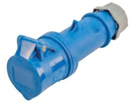
CEE-Kupplungsdose 3-pol., IP44 230 V, 16 A, mit Schraubanschlüssen
