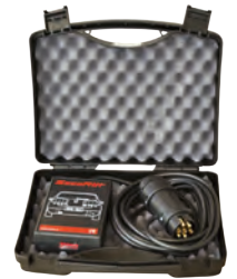
Prüfbox für Zugfahrzeug 7 + 13-pol., 12 Volt microprozessorgesteuert für CAN-BUS und normaler Elektrik Prüfung der Steckdose nach DIN/ISO, zusätzliche Anzeige der Masseanschlüsse Prüfkabel 5000 mm, mit Kunststoffkoffer
