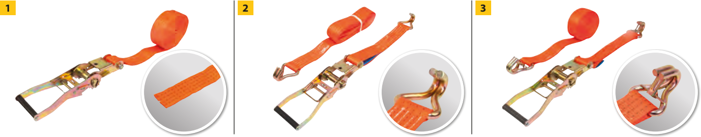
Zurrgurt mit Druckratsche, U 4000 daN, LC 2000 daN (bei Handkraft SHF 50daN - Vorspannung STF 300 daN)
