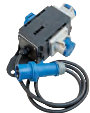
CEE-Stromverteiler Eingang: CEE-Stecker mit 1500 mm Zuleitung Ausgang: 2 CEE-Steckdose 1 Schutzkontaktsteckdosen 230 V, 16 A, max. 3500 W
