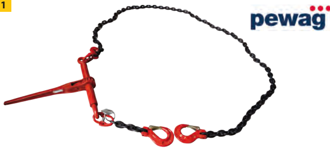
Verzurrkette 1-teilig , Länge 3500 mm Ratschenlastspanner auf einer Seite fest eingebaut
