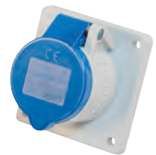
CEE-Anbausteckdose 3-pol., IP44 mit Dichtungsring, 230 V, 16 A Maße 75 x 75 mm, Lochabstand 60 mm
