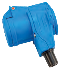
CEE-Winkelkupplungsdose 3-pol., IP20 mit integrierter Schutzkontaktsteckdose 230 V, 16 A, mit Schraubanschlüssen
