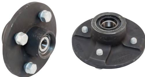
Laufnaben WAP inkl. Kegelrollenlager und Radbolzen
