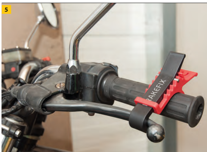
BrakeFix , verstellbarer Clip für die Motorradbremse
