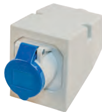
CEE-Anbausteckdose 3-pol., IP44 mit Dichtungsring, 230 V, 16 A Maße 75 x 75 mm, Lochabstand 60 mm
