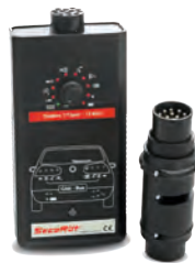
Funk-Diagnosegerät Prüfbox für Anhängersteckdose und Stecker 7 + 13-pol., 12 Volt, für Fahrzeuge mit und ohne CAN-Bus System geeignet, Eigene Stromversorgung für Anhängerbeleuchtung Profigerät für Werkstätten
