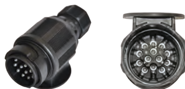
Stecker 12 Volt, 13-pol. Kunststoff, Schraubanschluss, drehbar mit 13 Steckerstiften
