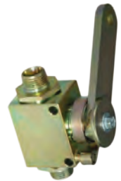
Hubbegrenzer, mechanisch für 12er Leitung, mit Flachfeder, Anschlüsse M18 x 1,5, gelb verzinkt
