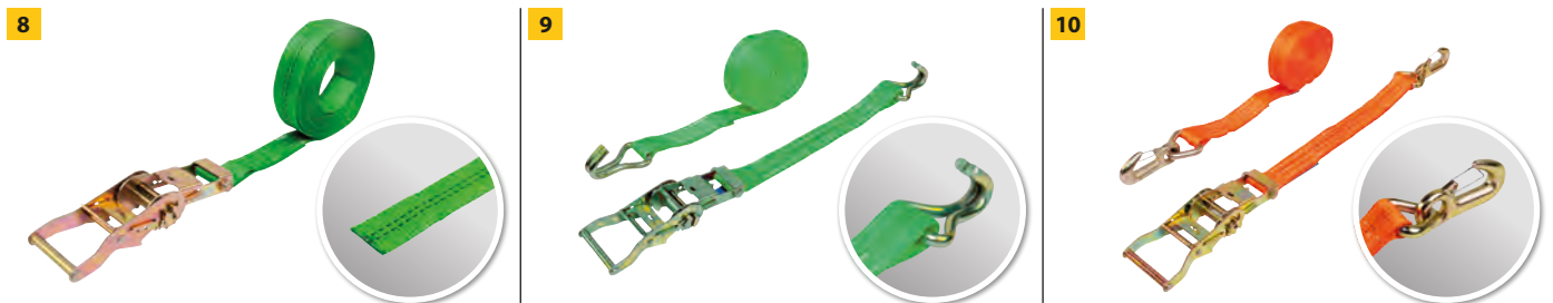
Zurrgurt mit Druckratsche, U 2000 daN, LC 1000 daN (bei Handkraft SHF 50 daN - Vorspannung STF 175 daN)
