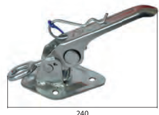
Excenterverschluss zum Anschrauben, mit Öse, verzinkt nicht abschließbar, mit Federstecker Höhe 55 mm, Lochabstand 64 mm, Bohrungs-Ø 8,2 mm
