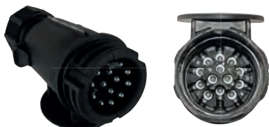
Stecker 12 Volt, 13-pol. steckbar mit 13 Steckerstiften, Schraubanschluss mit Kabeltülle für 1 Versorgungskabel, Kabel-Ø 8,5 mm
