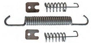
Federsatz für AL-KO für eine Radbremse, 2050 / 2051 / 2350 / 2360 und 2361
