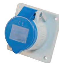
CEE-Anbausteckdose 3-pol., IP44 mit Dichtungsring, 230 V, 16 A Maße 75 x 75 mm, Lochabstand 60 mm
