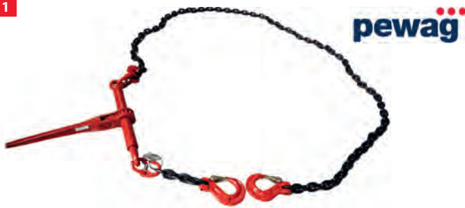
Verzurrkette 1-teilig , Länge 3500 mm Ratschenlastspanner auf einer Seite fest eingebaut, EN818-2-8, EN12195-3
