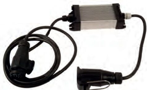
LED-Kontrollgerät mit Aluminium-Gehäuse 13-pol. Stecker und 13-pol. Kupplungsdose, 12 Volt, Kabellänge 2500 mm
