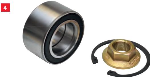
Kompakt-Radlagersatz für eine Bremstrommel - bestehend aus: 1 x Kompaktlager, 1 x Flanschnutter, 1-2 x Sicherungsring/e (Beim Austausch eines Kompaktlagers müssen Flanschnutter und Sicherungsring/e immer mitgetauscht werden.)
