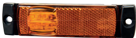
LED Seitenmarkierungsleuchte LED gelb, 12 / 24 Volt, mit DC-Kabel, Kabellänge 500 mm Maße 130 x 32 x 14,5 mm, Lochabstand 116 mm
