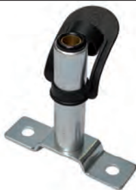
Adapter mit Schutzkappe und Halteplatte zur Montage von Rundumleuchten Lochabstand 80 mm, Ø 24 mm
