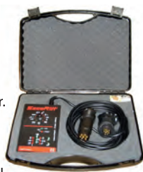
Prüfbox für Zugfahrzeug 7 + 13-pol., 12 Volt microprozessorgesteuert für CAN-BUS und normaler Elektrik Prüfung der Steckdose nach DIN/ISO, zusätzliche Anzeige der Masseanschlüsse Prüfkabel 5000 mm, mit Kunststoffkoffer
