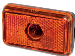
LED Seitenmarkierungsleuchte LED gelb 12 / 24 Volt, mit DC-Kabel, Kabellänge 500 mm, Maße 110 x 45 x 17,5 mm
