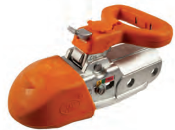
Zugkugelkupplung SPP mit Soft-Griff und Schloss
