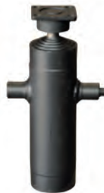
Teleskopzylinder mit Kugelpfanne, einfachwirkend, max. Druck 250 bar für Fahrzeuge bis max. 5,0 t zGG., Stufen-Ø 45 / 61 / 76 mm (015 001 048 - 45 / 61 / 76 / 91 mm), *Bauhöhe ohne Kugel
