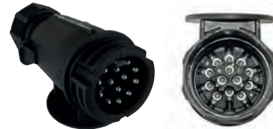
Stecker 12 Volt, 13-pol. steckbar mit 13 Steckerstiften, Schraubanschluss, mit Kabeltülle für 2 Versorgungskabel, Kabel-Ø 8,5 mm
