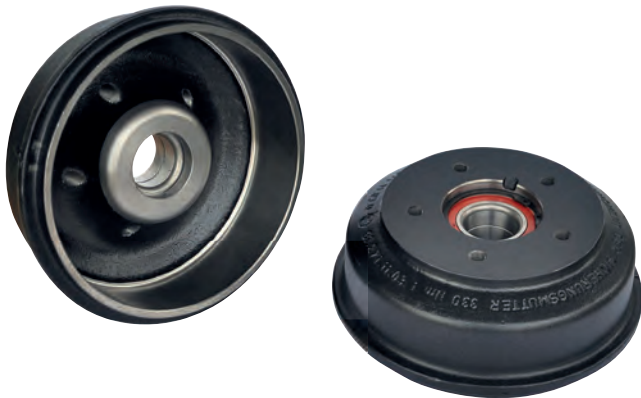
Bremstrommel BPW S2005-7RASK, 200 x 50 , inkl. Kompaktlager RALA8730S - 34 / 64 / 37 mm, Lagersitztiefe 11 mm
