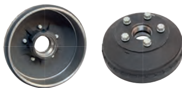
Bremstrommel WAP W235RS, 230 x 50 inkl. Kegelrollenlager RALA895, 30206 + 32008X, ohne Radschraube
