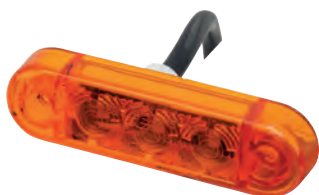
LED Seitenmarkierungsleuchte LED, orange 12 Volt, mit DC-Kabel, Kabellänge 500 mm, Maße 65 x 44 x 28 mm
