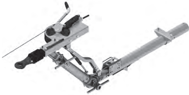
Auflaufeinrichtung höhenverstellbar Knott KHA mit Auflagebock
