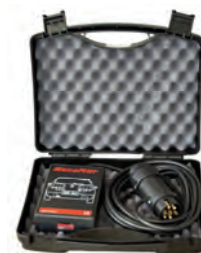
Prüfbox für Zugfahrzeug 7 + 13-pol., 12 Volt microprozessorgesteuert für CAN-BUS und normaler Elektrik Prüfung der Steckdose nach DIN/ISO, zusätzliche Anzeige der Masseanschlüsse Prüfkabel 5000 mm, mit Kunststoffkoffer
